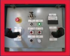
**Controles de viaje:** Sistema actuado hidráulicamente por controles para movimientos vertical y horizontal. Dos controles joysticks se encuentran en el panel del operador.
