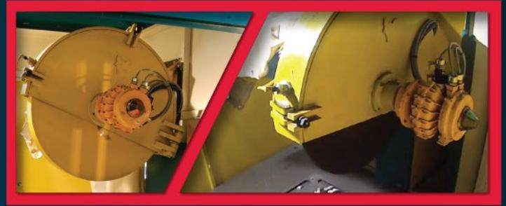
**Sistema de alineación por láser:** un láser de baja intensidad montado en la máquina para fácil alineación del disco de corte.
