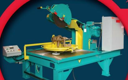
标准空气浮动切割机提供了使用周转台方便的移动重型铸件，且手动移动锯床的便捷性。你可以访问我们的网站或扫描下面的二维码，来获取比如图片，视频和宣传册等的信息。
