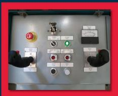
**进给控制:** 系统是可以液压驱动控制垂直和水平运动的。两个手柄控制器安装在操作员面板
