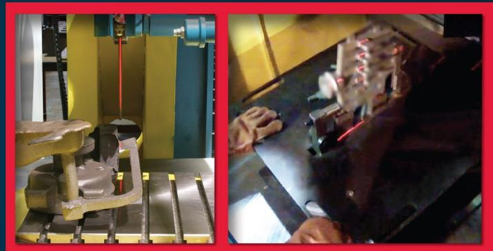
**机体:** 为了维修和进入切割机的方便，左右两边都可以配备铰链门。前门是支撑在过顶导轨上的。门上有个可以方便更换的防止飞溅的树脂窗。机体的后面为了水平进给留了个开口。为了减少飞屑进入到周围环境，水平进给附近留有开口。为了吸尘，机体的顶部留有一个标准的法兰圆接口。
