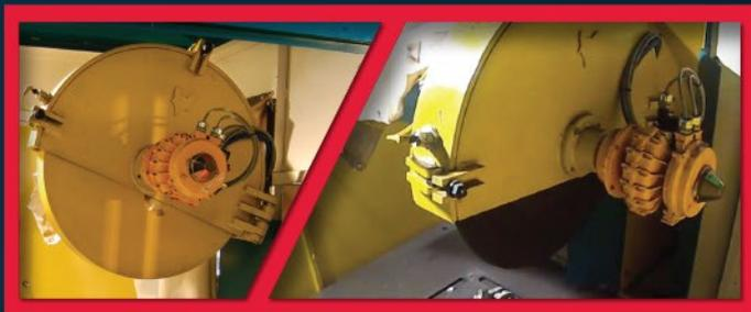
**Система выравнивания гондолы при помощи лазера:** на станке установлен лазер малой мощности для лёгкого выравнивания отрезного круга относительно отливки.
