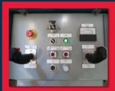
**Управление перемещением:** система с гидравлическим приводом для управления вертикальным и горизонтальным перемещением. На панели оператора расположены два джойстика управления.
