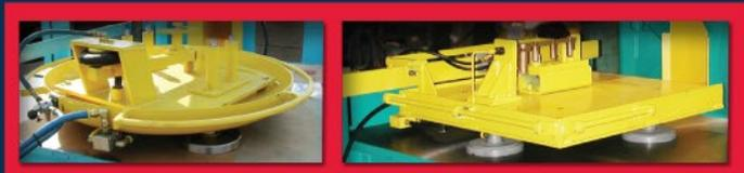
**Гидравлическое устройство:** для гидравлического прижима с запуском «по требованию».
