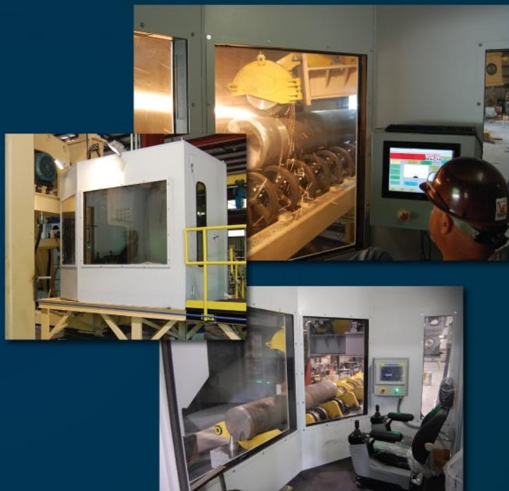
只要上载平台上至少有一个工件，累积步进梁将移走此工件所以当打磨操作员为下一个工件做好准备后将不会有延迟。下装累积步进梁反向工作，确保总是留有空间供小车自动卸载工件。
