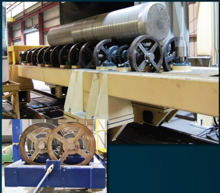
适用于受限的空间。圆形件旋转体配上“减速”可以保护小车，旋转轮和驱动轴，当上载设备和程序可允许材料掉落在小车上时推荐使用。
