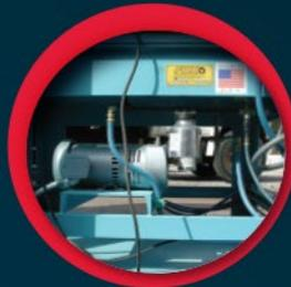
**Sistema Neumático/Vacío:** Pedal de control eléctrico operado por pie para flotación para tener manos libres para posicionar la góndola. Parte neumática permite flotar a la góndola para movimientos sencillos; la parte de vacío asegura la góndola a la mesa durante el corte.
