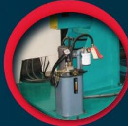
**Unidad Hidráulica:** para fuerza hidráulica de fijación operando "bajo demanda".
