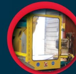
**Puerta de Seguridad del Operador:** la puerta de seguridad del operador tiene una ventana de plástico con cubierta de plexiglás fácilmente reemplazable. Esto permite al operador ver de manera segura el material en corte. La puerta de seguridad está enlazada con el circuito de seguridad, permitiendo al disco ser operado solo con la puerta cerrada.
