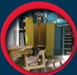
**Sistema de Alineación por Láser:** un láser de baja intensidad montado en la máquina para fácil y rápida alineación del disco de corte.
