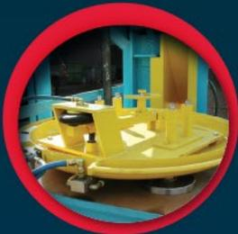
**Góndola para Pieza:** se estabiliza con tres apoyos de flotación. Con pedal operado por un pie para flotación para tener manos libres para posicionar la góndola. La góndola se asegura a la mesa por vacío durante el corte. Se ofrecen fijadores adicionales.
