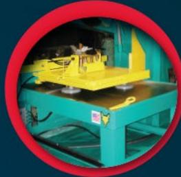
**Mesa de Flotación:** mesa construida con pulido parejo para uso rudo. La mesa puede voltearse si se desgasta o daña, o cambiarse por otra.
