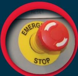
**Funcionalidad de Paro de Emergencia:** Hay tres diferentes interruptores de paro de emergencia que pueden utilizarse en este sistema. Hay dos botones de paro, uno en la consola del operador y la otra localizada en panel eléctrico. La tercera opción es un interruptor para pie enlazado al sistema de paro de emergencia para uso rápido y manos libres.
