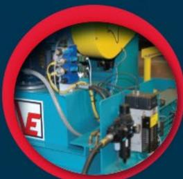
**Válvulas de Paro de Seguridad:** los sistemas neumático e hidráulico incorporan el uso de válvulas redundantes de paro de seguridad con monitoreo.
