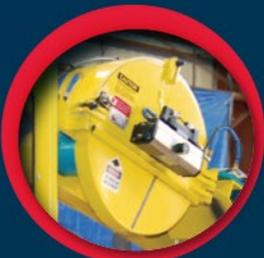
**Guarda de Seguridad del Disco Rotatorio:** esto permite al operador mover, realinear o cambiar piezas de manera segura sin parar el motor cada ocasión. La tecnología de la guarda del disco incluye sensores conectados a un circuito de seguridad. Cuando se mueve la manejera hacia abajo para comenzar el corte, la guarda se abre, permitiendo al operador ejecutar un corte.
